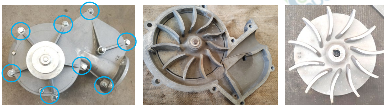
拆解螺栓位置
