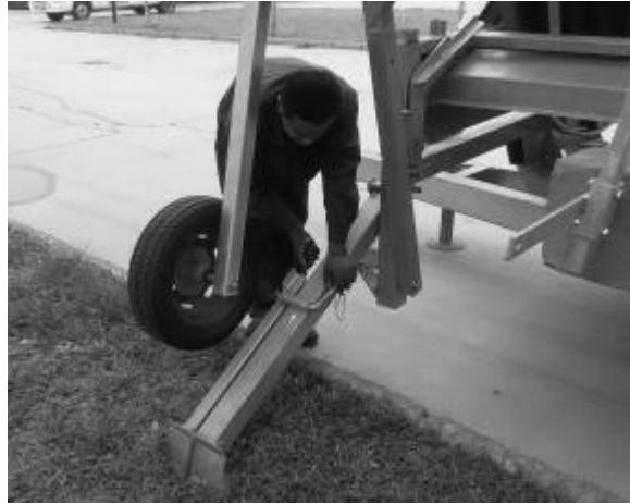
结束灌溉：抬起锚桩支腿插入锚桩固定销固定在侧支撑上，再收起锚桩总成并用 68 大拐销固定锁紧。该地块灌溉结束，移动机器至下一灌溉位置。
