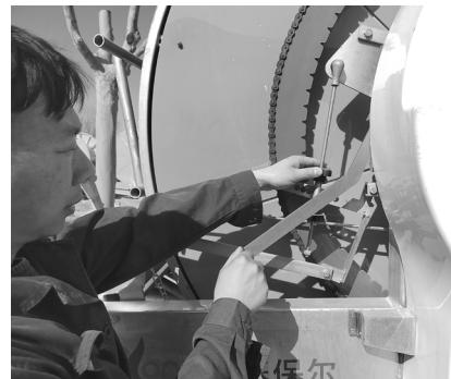
12. 喷水行车回收至主机前，关闭杆将喷水行车抬升，同时变速箱自动脱档，从而结束回卷过程。PE 管回收完毕后，继续喷灌 5 分钟，然后关闭给水栓或水泵，将连接软管与水栓脱开。
