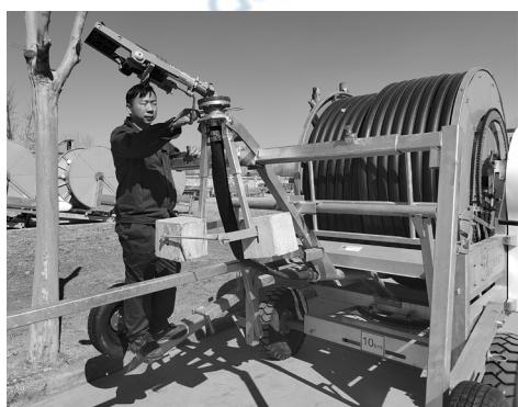
6. 设定喷枪的扇形喷洒范围，通常情况下建议设定为  $180^{\circ} \sim 220^{\circ}$
