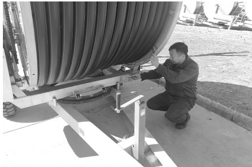
3. 取下锚桩总成上的 68 定位销，调整合适的角度后再拔下锚桩支腿上的锚桩固定销直接插入地下。并使锚桩支腿支撑在侧支撑的锚桩定位板上。若地面较硬，必须挖掘出足够深的坑以放下锚桩头。
